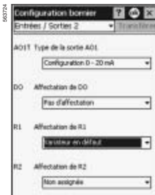
A hiba relé konfigurálása PowerSuite-tal zsebszámítógépek számára
